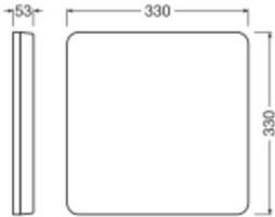
Technische Daten Ledvance Led-Wand- Und Deckenleuchte Surface Eben Lichtquellen Quadrat Weiß 16W 2660lm - 830-840 CCT | 300mm - IP20
